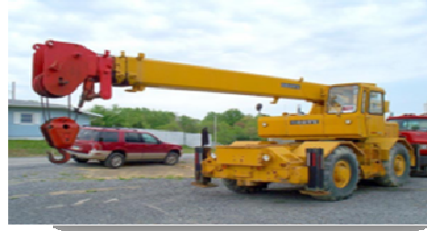
Resim 2: Lastik Tekerlekli Vinçler
