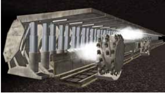
Resim 2: Kesici-Yükleyici Makine ve Hidrolik Tahkimatlar
