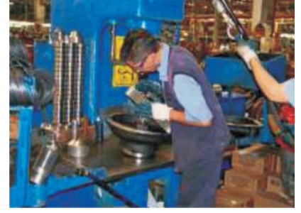
Şekil 7. Kapağın aks üzerine montaj işlemi
