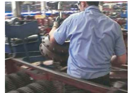
Şekil 3. Kapakların paletten alınması
