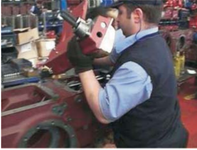
Şekil 13. Kapağın gövdeye montajı için taşınması
