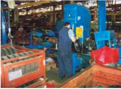
Şekil 4. Kapağın tersyüz edilmesi işlemi
