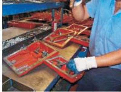
Şekil 10. Vites kapağı üzerinde çekiç ile çakma işlemi
