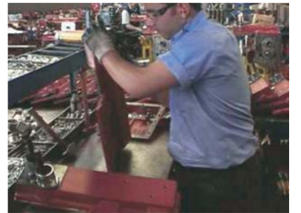
Şekil 12. Vites kapağının masa üzerinde ters yüz edilmesi
