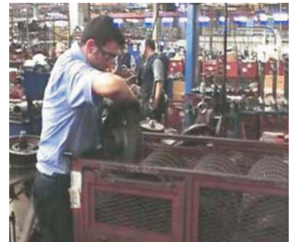
Şekil 8. Cer dişlisini paletten alma işlemi
