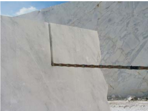
Resim 2: Elmas Tel Kesme Makinesiyle Kesim İşlemi (Sol) ve Elmas Tel (Sağ)
